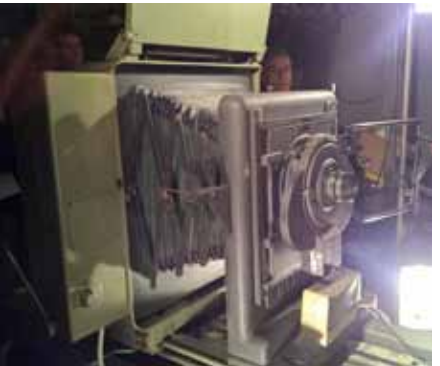
Eine historische Reprokamera ist aufgrund ihrer hohen Auflösung weiterhin fest in den Produktionsprozess eingebunden.
