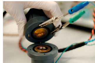
Experimenteller Versuchsaufbau einer am InES konzipierten Zink-Luft-Batterie
